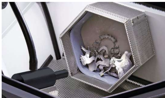
Экономия времени и затрат: большая вращающаяся струйная корзина позволяет одновременно обрабатывать до 7 объектов
