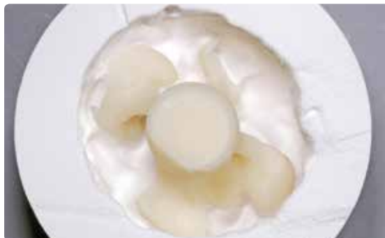
Черновая распуковка проводится стеклянной дробью под давлением 4 бара, пока объект не станет видимым.
