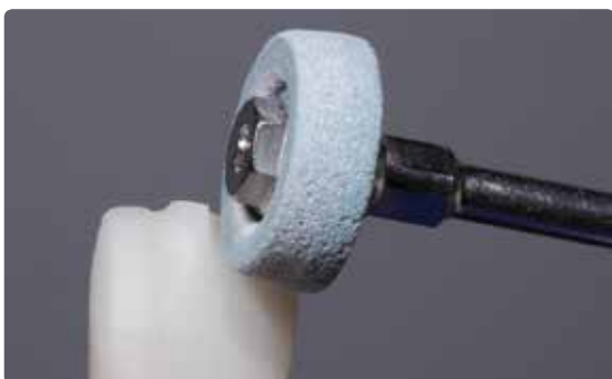
Сглаживание мест прикрепления литников с низкой скоростью и легким давлением, обработка поверхности
