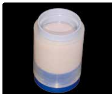
Опоку заполнить до отметки и вставить ограничитель IPS Investment Ring Base. Ограничитель вдавить до щелчка в силиконовое кольцо IPS Silicone ring. Излишки паковочной массы будут выходить через отверстие. Оставьте запакованную опоку затвердевать, не используйте вибростол.
