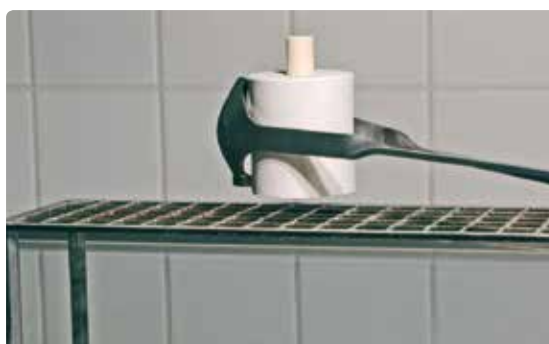
После окончания программы прессования с помощью щипцов выньте опоку из печи и поставьте ее на решетку для охлаждения до комнатной температуры.
