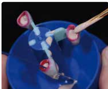
Полости осторожно заполните паковочной массой подходящим инструментом (например, кисточкой).
