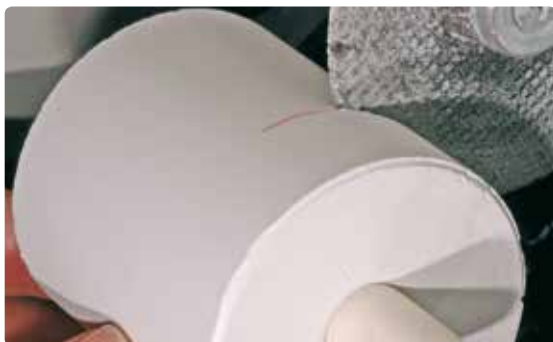
Надрежьте опоку с помощью сепарационного диска и разломите ее по сделанному надрезу.
