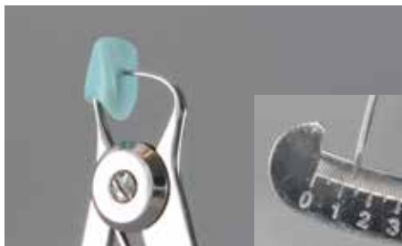
Определение толщины слоя вручную по центру в самом тонком месте с вестибулярной стороны.
