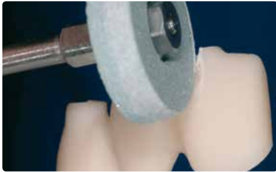
Загладьте места прикрепления литников при низкой скорости и незначительном давлении
