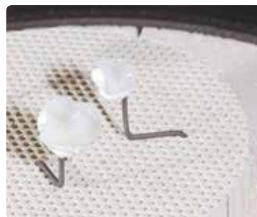
Обжиг глазури проводится с соответствующими параметрами обжига на трегере с сотовой структурой.
