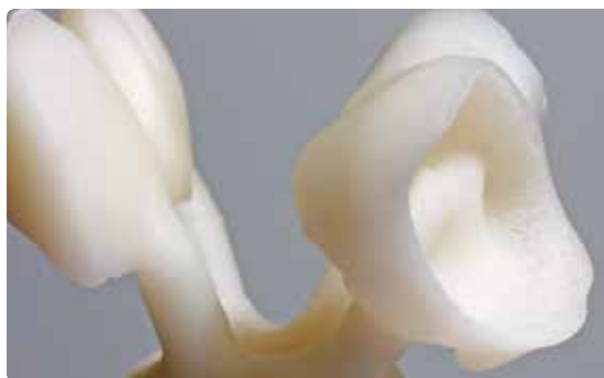
Удалите реакционный слой, образовавшийся на прессованных объектах, жидкостью Invex в ультразвуковой ванне.
