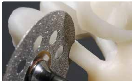
Отрезание литников в случае монохромной реставрации.
