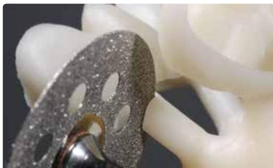
Отрежьте литники с помощью тонкого алмазного диска, место отреза должно постоянно увлажняться.
