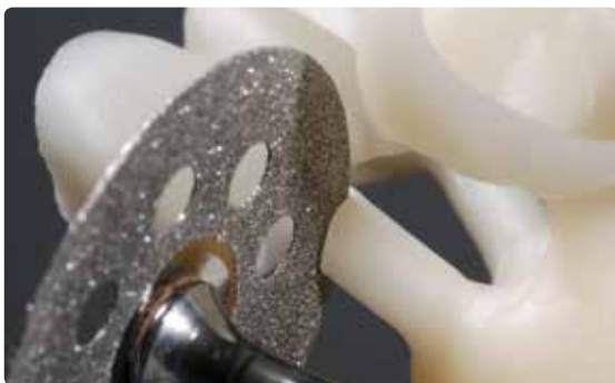
Отрезание литников с помощью тонкого алмазного диска, место отреза постоянно увлажняется
