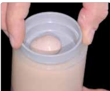
Опоку заполнить до отметки и вставить ограничитель IPS Investment Ring Base. Ограничитель вдавить до щелчка в силиконовое кольцо IPS Silicone ring. Излишки паковочной массы будут выходить через отверстие. Оставьте запакованную опоку затвердевать, не используйте вибростол.
