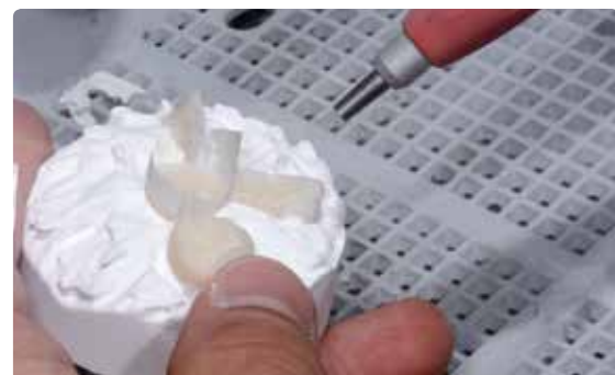
Черновая распаковка проводится стеклянной полировочной дробью под давлением 4 бара, пока не станут видными объекты прессования.
