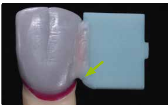
Закройте зазор между заготовкой IPS Multi Wax Pattern и моделировкой небольшим количеством моделировочного воска, чтобы не возникло утолщений. В исключительных случаях скруглите эту область на заготовке Wax Pattern.
