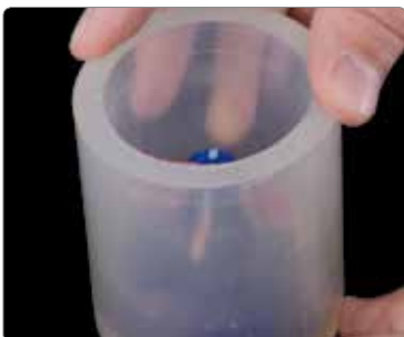
Осторожно наденьте кольцо IPS Silicone Ring 200 г на цоколь опоки IPS Multi Investment Ring Base 200 г. Следите за тем, чтобы кольцо было полностью посажено на цоколь.
