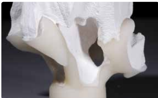
Окончательная распуковка проводится стеклянной дробью под давлением 2 бара.
