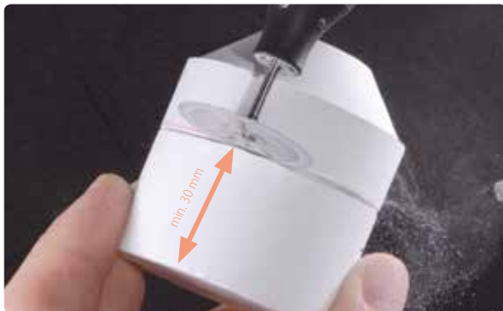
Надрежьте опоку с помощью сепарационного диска на расстоянии как минимум 30 мм от дна охлажденной опоки...
