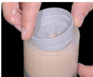
Опоку заполнить до отметки и вставить ограничитель IPS Investment Ring Base. Ограничитель вдавить до щелчка в силиконовое кольцо IPS Silicone ring. Излишки паковочной массы будут выходить через отверстие. Оставьте запакованную опоку затвердевать, не используйте вибростол.
