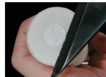
Снимите «головку» формовочной массы, образованную выравнивающей крышкой
