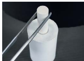
Вставка плунжера Noritake EX-3 PRESS Dispo Plunger
