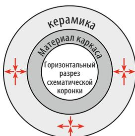
Идеальное распределение тангенциального напряжения растяжения и сжатия имеет место, когда КТР керамики оптимально соотносится с КТР каркасного материала.
