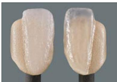
Легкий глянец на поверхности керамики свидетельствует о правильности обжига. Если же керамика имеет молочный неравномерный вид, значит, температура была слишком низкой. Увеличивая поэтапно температуру на 5–10°C, найдите приемлемый температурный режим.
