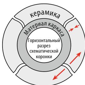
Если КТР каркасного материала намного ниже КТР облицовочной керамики, то тангенциальные напряжения растяжения повышаются и вызывают разрывы, проходящие радиально наружу. Это может привести к поздним трещинам.
