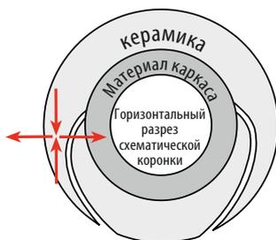
Если КТР каркасного материала намного выше КТР облицовочной керамики, то повышаются тангенциальные напряжения сжатия и вызывают почти параллельные каркасу разрывы. Это может привести к сколам керамики.
