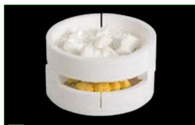
9 Одновременная синтеризация предварительно окрашенных Color/Multicolor- и вручную окрашенных реставраций.
