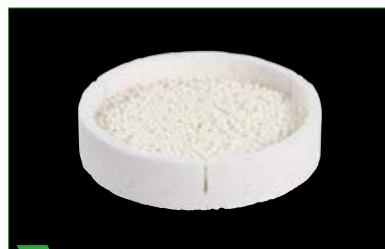
3 Заполнить синтеризационную чашку MS синтеризационными шариками (мин. 3 слоя циркониевых шариков).
