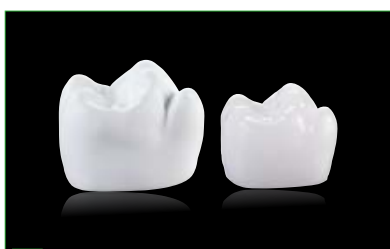
4 Моляр до и после спекания; Усадка при спекании ок. 20 процентов
