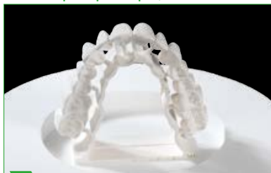
5 Отсоединенные и обработанные реставрации с синтеризационными опорами.
