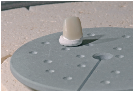
После окончания программы кристаллизации выньте лоток для обжига из печи и дайте реставрации IPS e.max CAD остыть до комнатной температуры.
