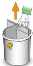
При очистке ослабить винтик на сливе, отвинтить крышку, слить воду и вынуть коллектор.
